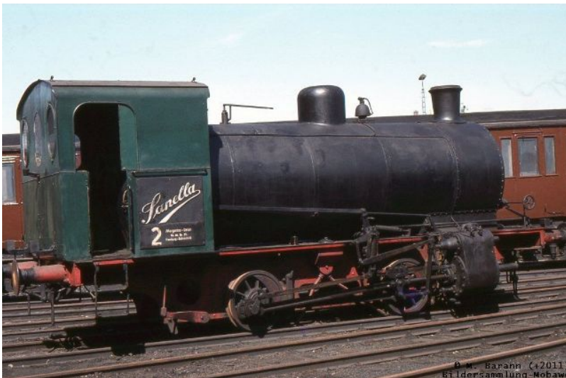
Dampfspeicherlok Sanella im April 1980 Bw Rothenburgsort
