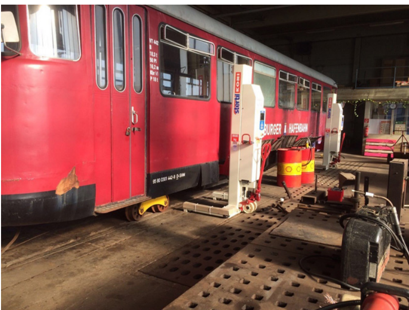
Deshalb steht der Schienenbus auf Hilfsfahrgestellen
