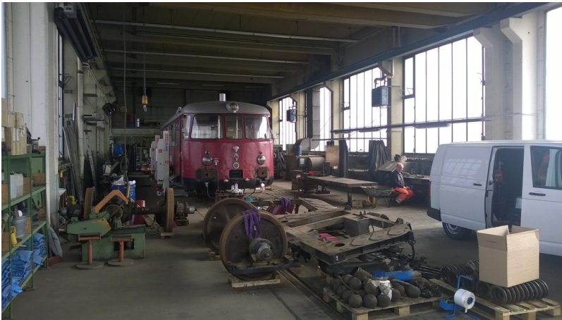
Im Vordergrund die demontierten Fahrgestelle
