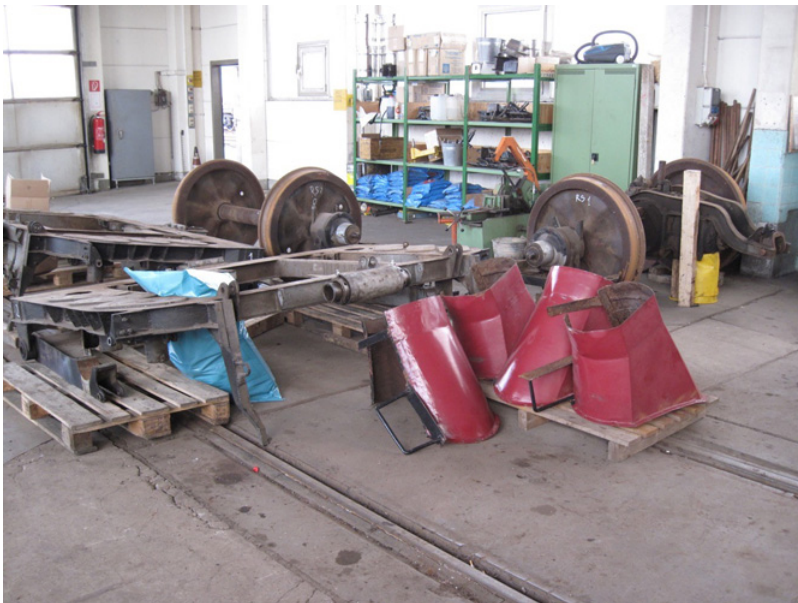
Auch die Pufferverkleidungen wurden demontiert...
