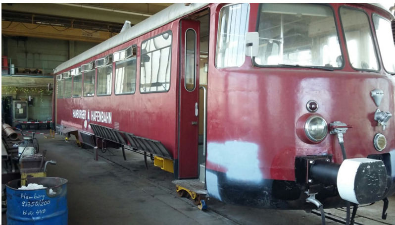
Überall wurden weitere Schäden an der Karosserie entdeckt und beseitigt...
