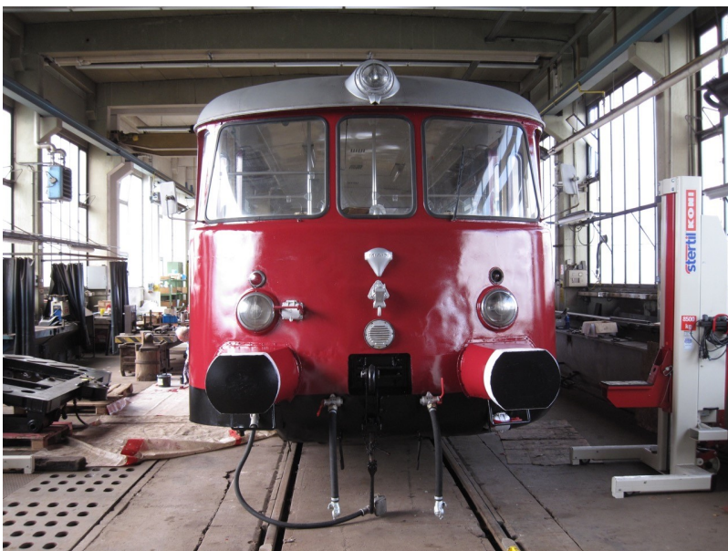
...und bis auf das Dach alles neu lackiert
