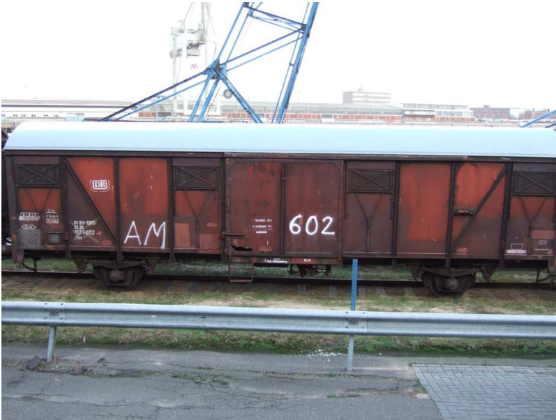
Mit saniertem Dach
